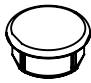
Cap of door guide Capuchon pour guide de porte Capuchón para guía de puerta 2x
