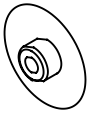
Cap of outer door roller Capuchon de rouleau extérieur de porte Casquillo del rodillo externo de la puerta 2x
